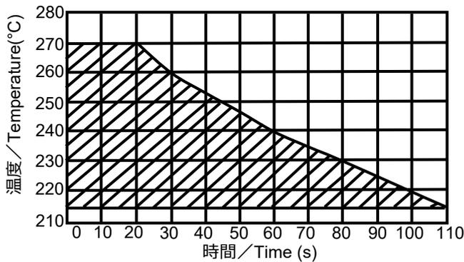
(5) リフロー方式での推奨はんだ付け条件 / Recommended Temperature Profile for Soldering
