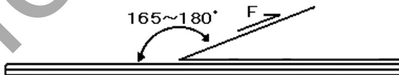
剥離角度 Peeling angle : 165°-180° テープ接着面に対して
