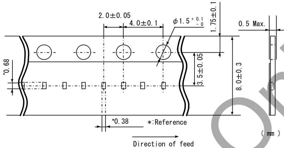
(1) 製品をベーステープのキャビティの中に収納し、トップテープとボトムテープをベーステープに貼付して封入します。
