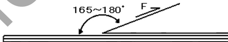
剥離角度 Peeling angle : 165°-180° テープ接着面に対して
