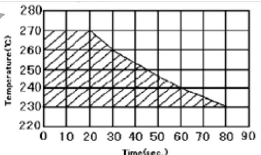
(5) リフロー方式での推奨はんだ付け条件 / Recommended Temperature Profile for Soldering
