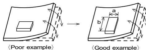
②基板ブレイク付近での部品配置
