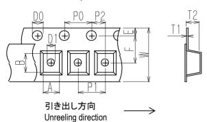
・シールテープ剥離強度 The force to peel away the fixing seal tape 0.1~1.0N
