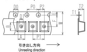
・シールテープ<sup>®</sup>剥離強度 The force to peel away the fixing seal tape 0.1~1.0N
