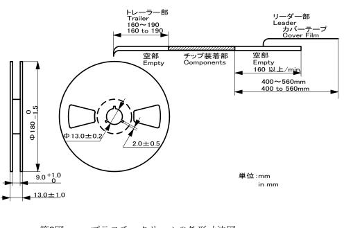
第3図 プラスチックリールの外形寸法図
