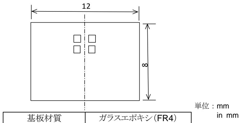
第6図 試験用基板
