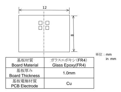
第6図 試験用基板 Figure6. Test Board
